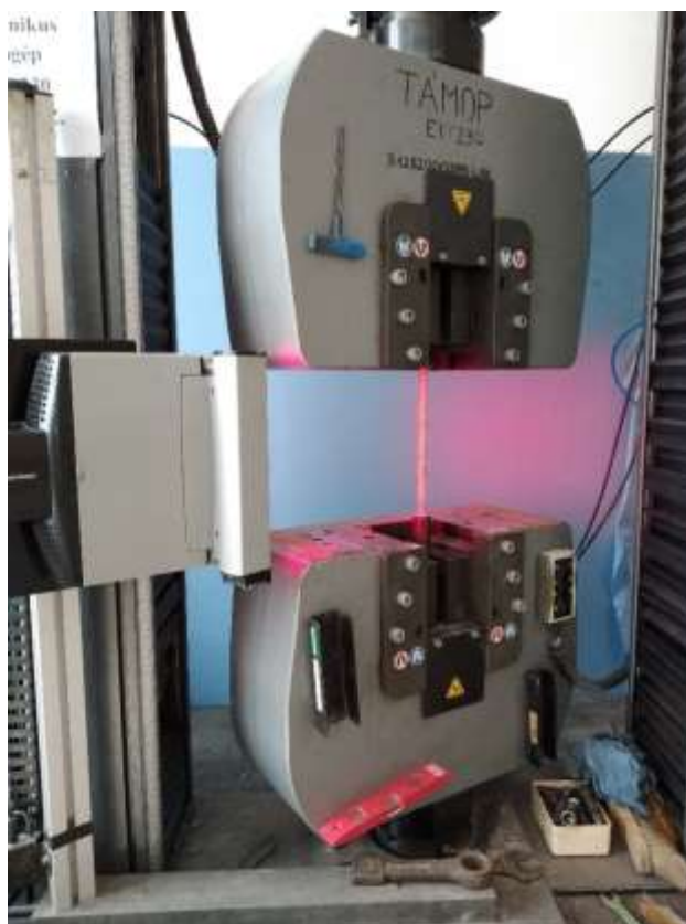
1. ábra: Jellemző kísérleti beállítás: Szakítószilárdság, rugalmassági modulus és fajlagos nyúlás vizsgálat (a fényképfelvétel nem az aktuális vizsgálatok alatt készült, csupán a kísérleti kialakítást hivatott bemutatni). Instron 5989 univerzális anyagvizsgáló gép és AVE1 Video extensometer
